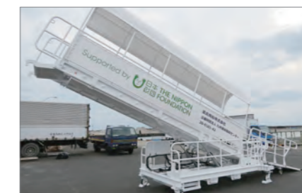
潮位の変化に応じ傾斜角度を変えられる「スロープ」「ステップ」対応可能。屋根のありなし、移動時の手動電動の別も希望に応じる
