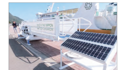
太陽光発電によりバッテリーの充電を行う
